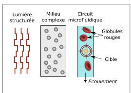
Fig. 1: Principe de l'expérience optique proposée, qui sera développée afin de détecter la présence d'une cible parmi des globules rouges, et de focaliser la lumière sur cette cible.
